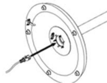
Paso 4: Pasar el enchufe del cable de alimentación por la base, el tubo inferior, el tubo intermedio y el tubo superior. Conecte el enchufe del cable de alimentación al enchufe del cabezal de la estufa de pie.
