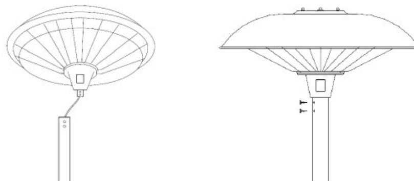
Paso 6: Con cuidado, saque todo el cable de alimentación que se puede de la base. Fije el cable de alimentación en la parte inferior de la base con las 4 tuercas M4.
