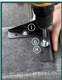
5. Atornillamos las patas (I) a los brazos (F) utilizando los herrajes (G, H). \* La tirada de la pata de madera va hacia fuera.
