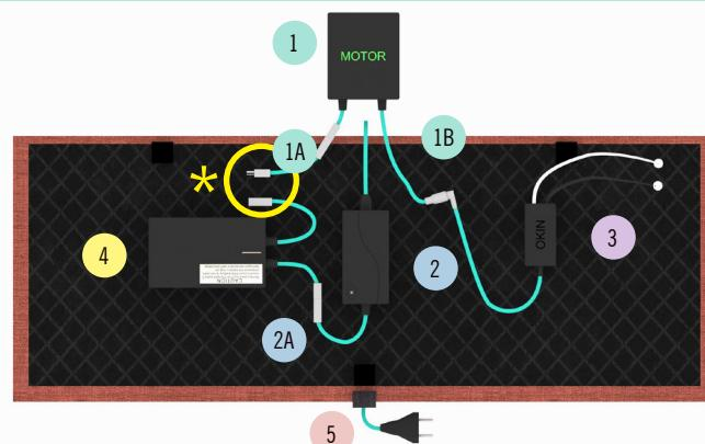
La conexión 1A va desconectada para evitar que se accione el motor en el transporte. Conectar para activar su funcionamiento.
