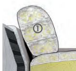
Respaldo Espuma./ Espuma Backrest 1. Espuma poliuretano densidad 20 kg/m 3 ./ Polyurethane foam density 20 kg/m 3 . 2. Fibra acrílica./ Acrylic fiber.
