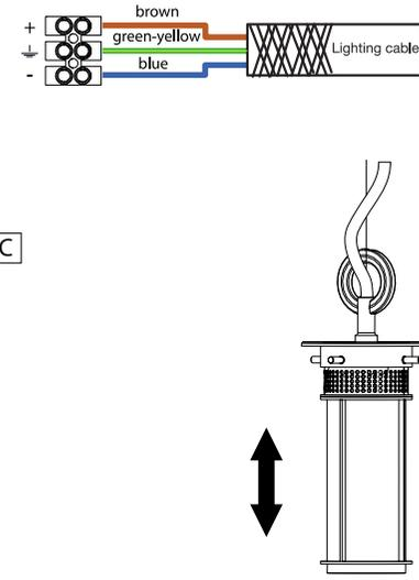
**ES** Ajustar la altura de la luminaria fijándola con la pieza (B). Realizar la conexión del florón a la luminaria como se indica en el esquema. Fijar el cable eléctrico con el prensacables (C). Posicionar el cubre florón sobre el soporte y fijarlo con la pieza grafiada (D).
