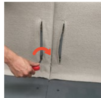
Tighten nuts in second back one half turn. Girar media vuelta los pasadores del respaldo.
