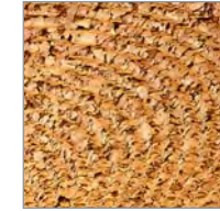
Corcho claro 98% natural con un 2% de colas biodegradables exentas de formaldehidos 98% natural light cork with 2% formaldehyde-free biodegradable glues 98% liège clair naturel avec 2% de colles biodégradables sans formaldéhyde
