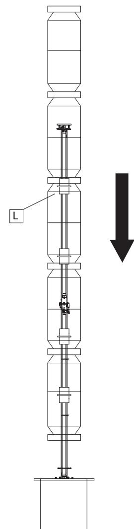
**ES** Colocar la pantalla (K) con cuidado sobre la estructura de la luminaria, la pantalla tiene posición por lo que introducir en primer lugar la parte marcada con la cinta negra. Una vez detectada, retirarla. Al introducir la pantalla es necesario ensanchar la tela para sobrepasar los soportes (L), hacerlo sin miedo.
