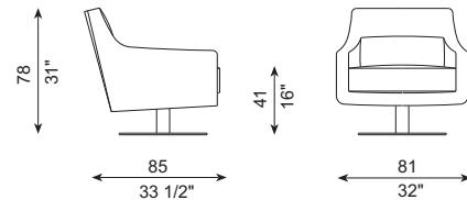
Estructura de madera recubierta con espuma de poliuretano de diversas densidades y con fibra de poliéster hueca siliconada. Cojín de asiento en espuma de poliuretano de diversas densidades de alta resiliencia y funda protectora. Suspensión mediante cinchas elásticas. Pies en acero cromado brillo, niquelados mate o grafito brillo. Pies desmontables mediante tornillos. No desenfundable.
