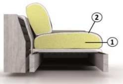
Coussin de siège type A « Bloc » / Сидение типа А « Блок » 1. Mousse de polyuréthane densité 33 kg/m 3 / Полиуретановая пена плотностью 33 кг/м 3 . 2. Fibre acrylique / Акриловое волокно.
