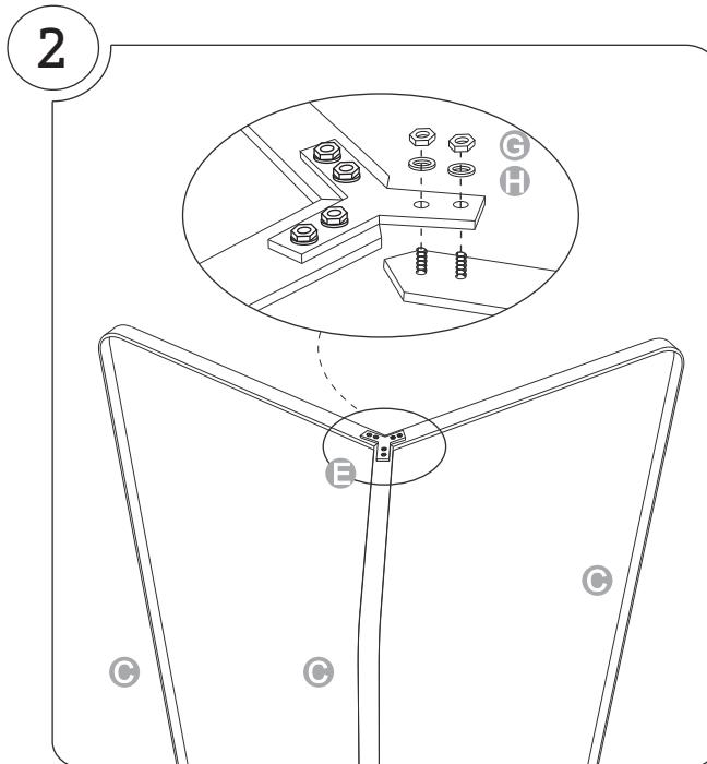
Girar la estructura para unir los pies en la parte inferior, ayudándonos con la pieza de unión, insertándola en los dos tornillos que hay en cada pie, fijándolos mediante 6 tuercas y 6 arandelas.
