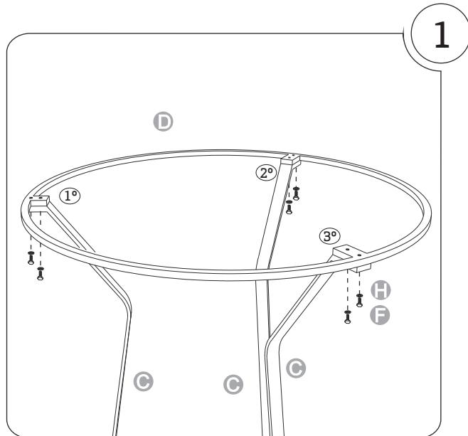
Atornillar los tres pies en su parte superior al aro mediante los 6 tornillos y 6 arandelas.
