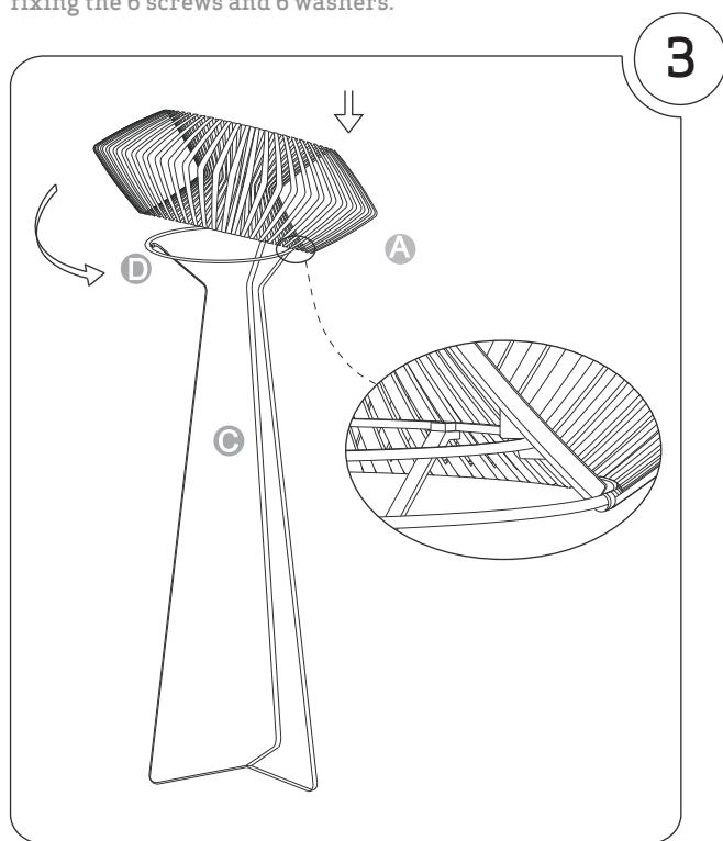
Colocar la tulipa de la lámpara sobre el aro posicionando dos enganches y ajustando el tercero.
